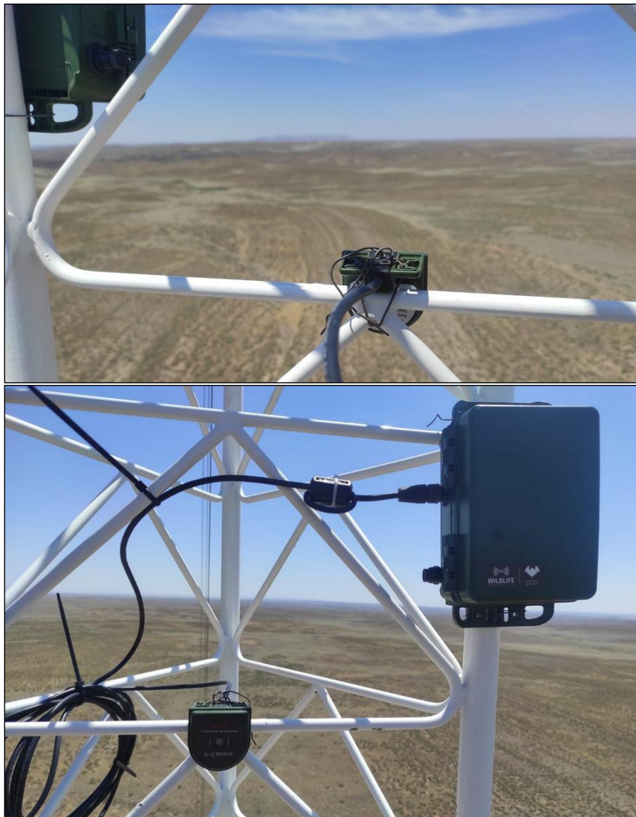
Рис. 12. Стационарный детектор, установленный на высоте 50 м на метеорологической мачте (фото Н. А. Девятериков; сверху – панорамный вид сектора регистрации микрофона, внизу – общий вид детектора и размещения микрофона). Для всех зарегистрированных эхолокационных сигналов рукокрылых рассчитывался показатель «относительная интенсивность». Относительная интенсивность определялась как частота регистрации сигналов конкретного вида среди всех зарегистрированных типов сигналов (за исключением шумов, социальных сигналов и неидентифицированных записей).
