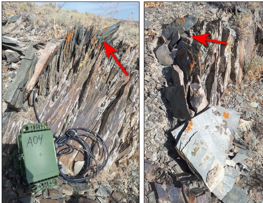
Рис. 11. Вариант скрытого размещения микрофона (обозначен красной стрелкой) стационарного детектора в камнях на горных склонах (слева – до маскировки детектора камнями, справа – после маскировки).
