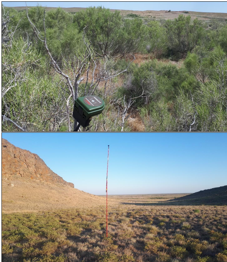
Рис. 10. Варианты размещения микрофонов стационарных детекторов не на горных склонах (вверху – микрофон детектора закреплен на вершине небольшого дерева; внизу – микрофон поднят на телескопических штативах высотой 2–5 м).
